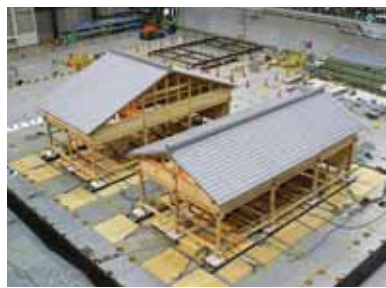
伝統工芸木造住宅震動台実験 (E-ディフェンス)
